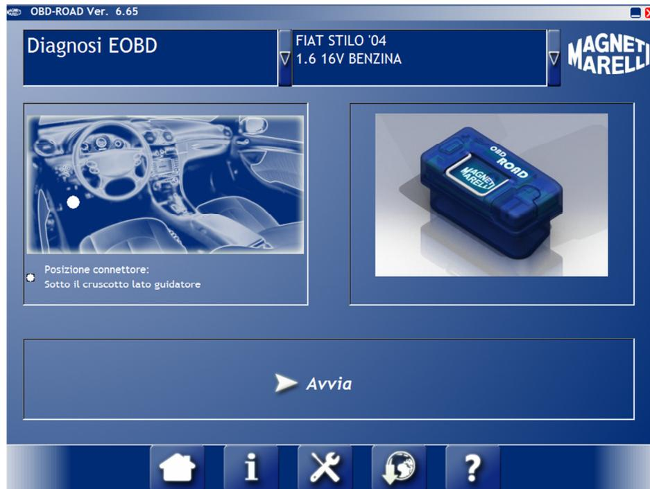
Il software vi mostrerà la posizione del connettore EOBD della macchina che state analizzando, connettete il dispositivo alla vettura e premete Avvia.
