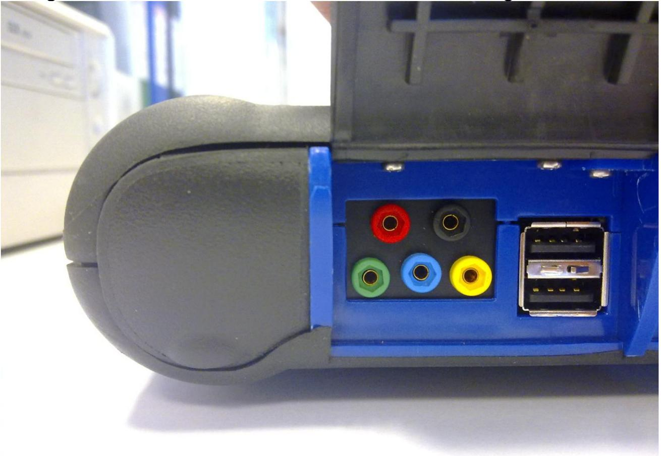
**ATTENZIONE** La boccia di colore nero è la massa. Per effettuare le misure è sempre necessario collegare questo cavo al segnale di massa del veicolo. Il colore delle altre bocche identifica il colore con il quale le tracce sono poi visualizzate sul video.
